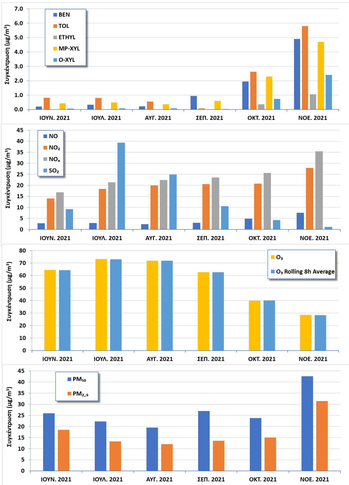
Σχήμα 2.1.3. Μέση μηνιαία διακύμανση των συγκεντρώσεων BTEX, NO x , SO 2 , O 3 , PM 10 και PM 2,5 κατά το χρονικό διάστημα 01.06.21 – 30.11.21
