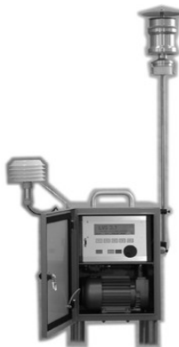
Δειγματολήπτης αιωρούμενων σωματιδίων PM 10 κατά EN-12341:2014
