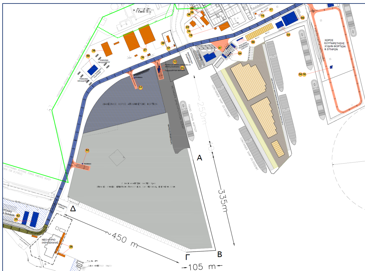
Εικόνα 4. Χαρακτηριστικά Μήκη Επέκτασης Κρητιδότοιχου και Θωράκισης του Προβλήτα Νο 3 (σημαίνεται με χρώμα ανοιχτό γκρι) σύμφωνα με το σχεδιασμό που έχει εγκριθεί από το Γενικό Προγραμματικό Σχέδιο (MasterPlan) Λιμένα Βόλου (ΦΕΚ 419 Τ.Α.Α.Π.Θ./26-11-2013 αρ. Σχεδίου 2.3).
